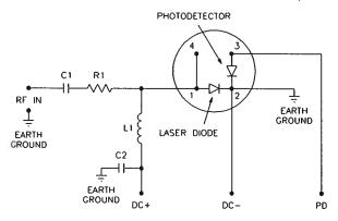
TYPE 2 LASER DIODE PACKAGE SHOWN
