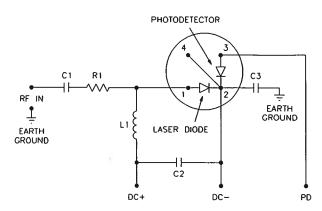
TYPE 2 LASER DIODE PACKAGE SHOWN
