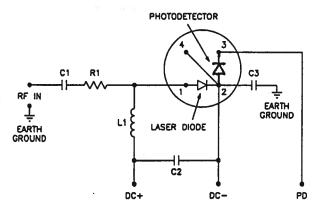
TYPE 3 LASER DIODE PACKAGE SHOWN
