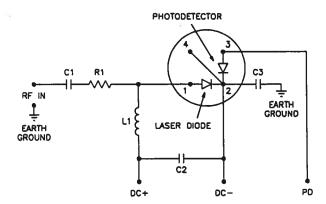
TYPE 2 LASER DIODE PACKAGE SHOWN
