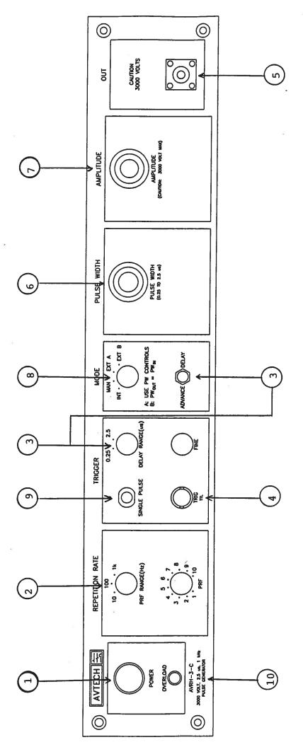
FIG. 2: FRONT PANEL CONTROLS
