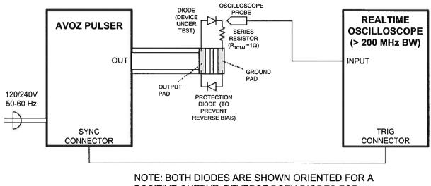
NOTE: BOTH DIODES ARE SHOWN ORIENTED FOR A POSITIVE OUTPUT. REVERSE BOTH DIODES FOR NEGATIVE OPERATION.
