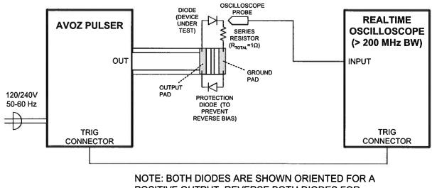
POSITIVE OUTPUT. REVERSE BOTH DIODES FOR NEGATIVE OPERATION.
