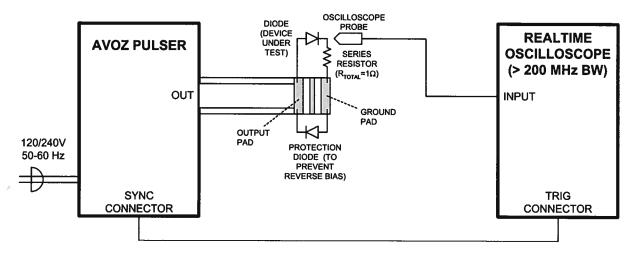
NOTE: BOTH DIODES ARE SHOWN ORIENTED FOR A POSITIVE OUTPUT. REVERSE BOTH DIODES FOR NEGATIVE OPERATION.
