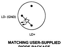
DIODE PACKAGE (BOTTOM VIEW). 5.6 mm PACKAGE.
